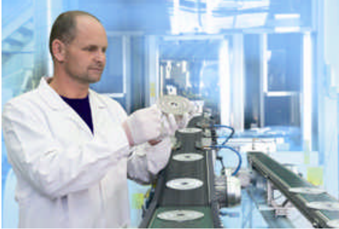
Metallische Interkonnektoren von PLANSEE werden pulvermetallurgisch und endformgenau gefertigt.
